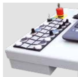
Controllo della pressione e del funzionamento dell'intensificatore gestito direttamente dalla console
