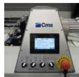
Controllo elettronico della pressione di taglio Software-based electronic control of cutting pressure
