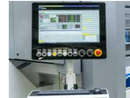
Hardware e Software di gestione dell'impianto di taglio waterjet progettati per offrire un'interfaccia con l'operatore semplice ed intuitiva e consentire una gestione completa di tutte le funzioni del sistema, compreso il controllo della conicità (JDC) per le macchine a 5 assi
